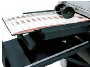
当仅进行压痕操作时，压痕装置可对400 gsm的厚纸张进行压痕。（需长纸张的止动器。）
