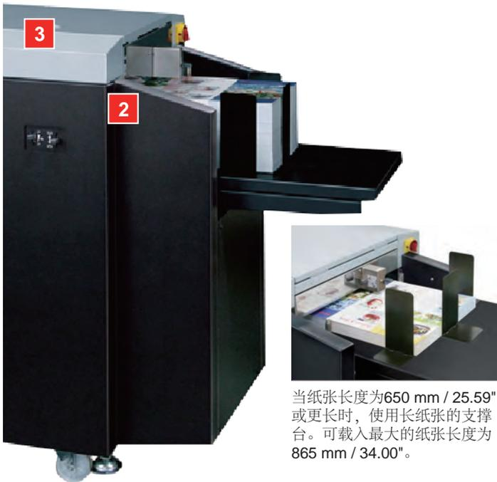
当纸张长度为650 mm / 25.59"或更长时，使用长纸张的支撑台。可载入最大的纸张长度为865 mm / 34.00"。
